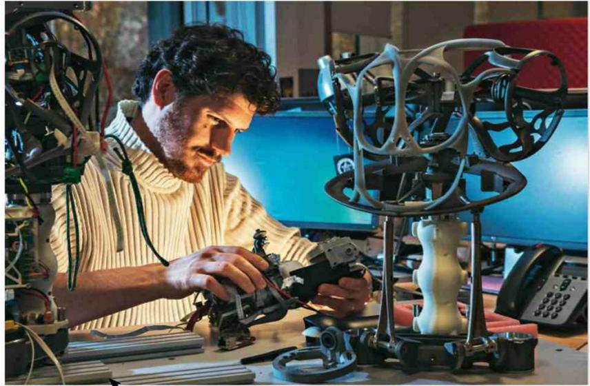
5 000 pièces, dont un thorax en acier et fibre de carbone, constituent le corps de Romeo.
